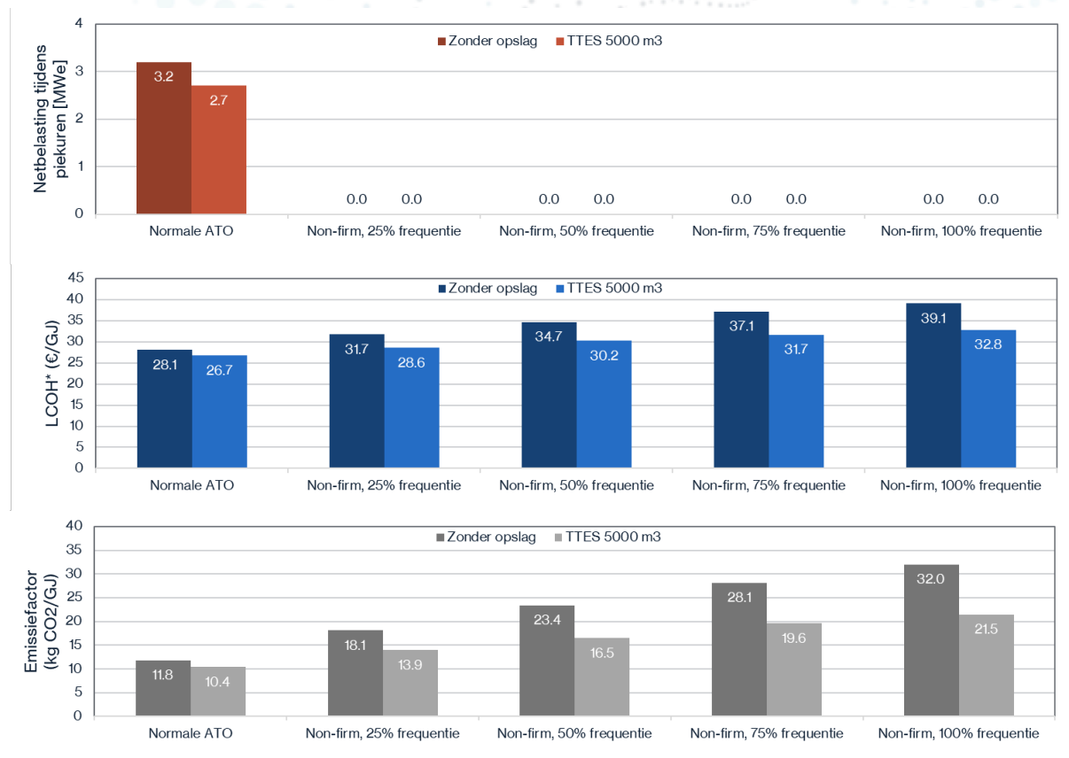
Figuur 14: Netbelasting tijdens piekuren, LCOH* en emissiefactor voor warmtenet uit casus 2 zonder warmteopslag en met een TTES van 5000 m 3 . LCOH* en emissiefactoren worden getoond voor een situatie met normale ATO en non-firm ATO met variërende frequenties waarbij transportbeperkingen worden afgeroepen binnen de tijdsblokken 06:00-10:00 en 16:00-19:00 (25-100%). LCOH* zijn de levelised cost of heat met de kosten binnen de scope van het model, dit zijn niet de totaalkosten van het warmtenet
