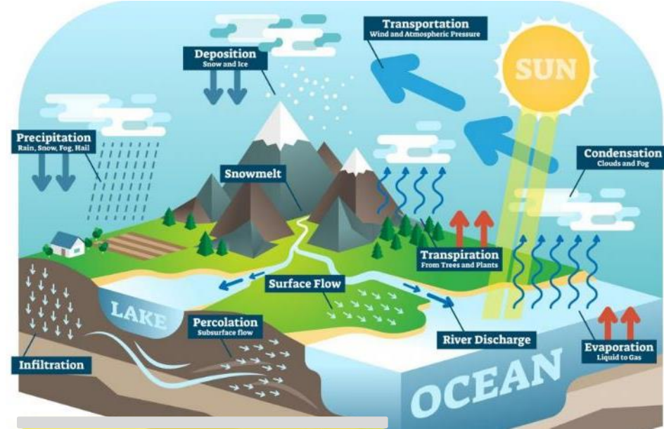
Een schematisch overzicht van de watercyclus en de bijbehorende processen
